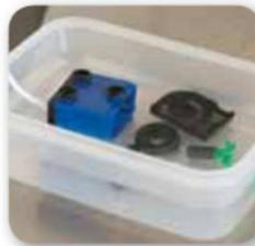
Si votre eau est très dure, et si du calcaire s'est déjà déposé sur la pompe, placez toutes les pièces pendant une heure dans un bol rempli d'une solution de détartrage. L'acide citrique dilué s'est avéré particulièrement approprié puisqu'à la différence de l'acide
