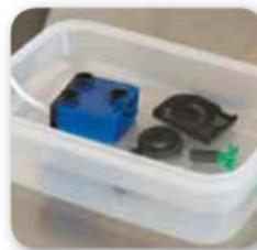
Haben Sie sehr kalkhaltiges Wasser und es haben sich schon Kalkablagerungen an der Pumpe abgesetzt, legen Sie alle Teile eine Stunde in eine Schale mit Entkalkerlösung. Als besonders geeignet hat sich verdünnte Zitronensäure erwiesen, da diese im Gegensatz
