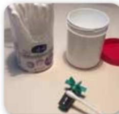
De temps en temps, vous devez graisser l'axe métallique sur lequel le rotor est inséré et l'aimant de l'hélice avec une touche de vaseline (supermarché, pharmacie). (C'est facile à faire avec un coton-tige, par exemple.)
